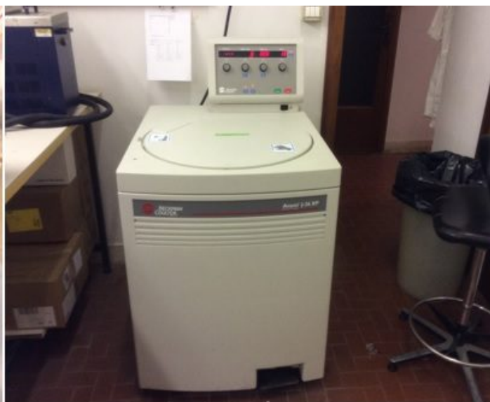
Centrifuga preparativa utilizzata per la purificazione del DNA di vite dai vini
