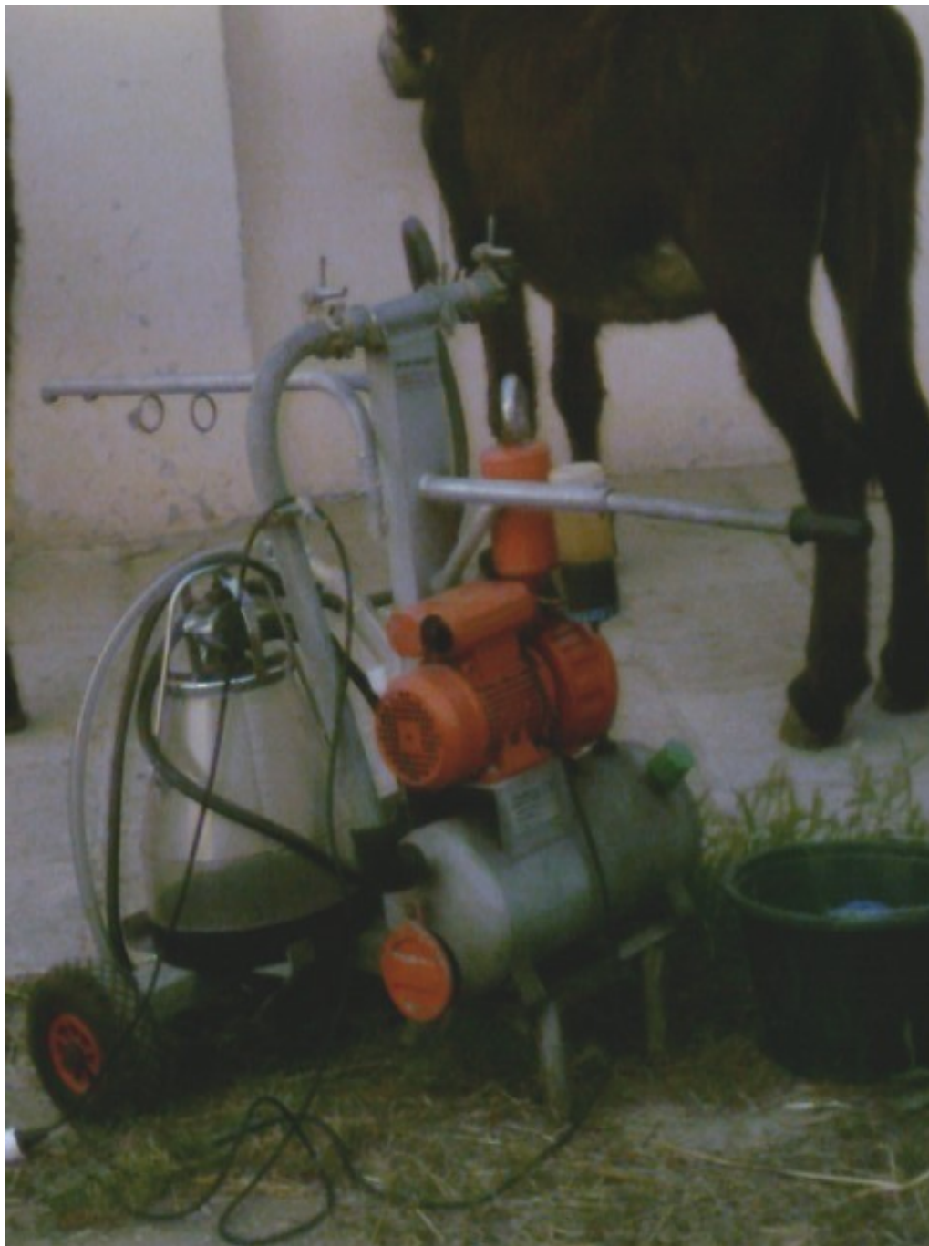
Fattrice di razza Ragusana con primo piano di mungitrice a carrello, comunemente adoperata per gli ovicaprini (foto F. Paolicelli)
