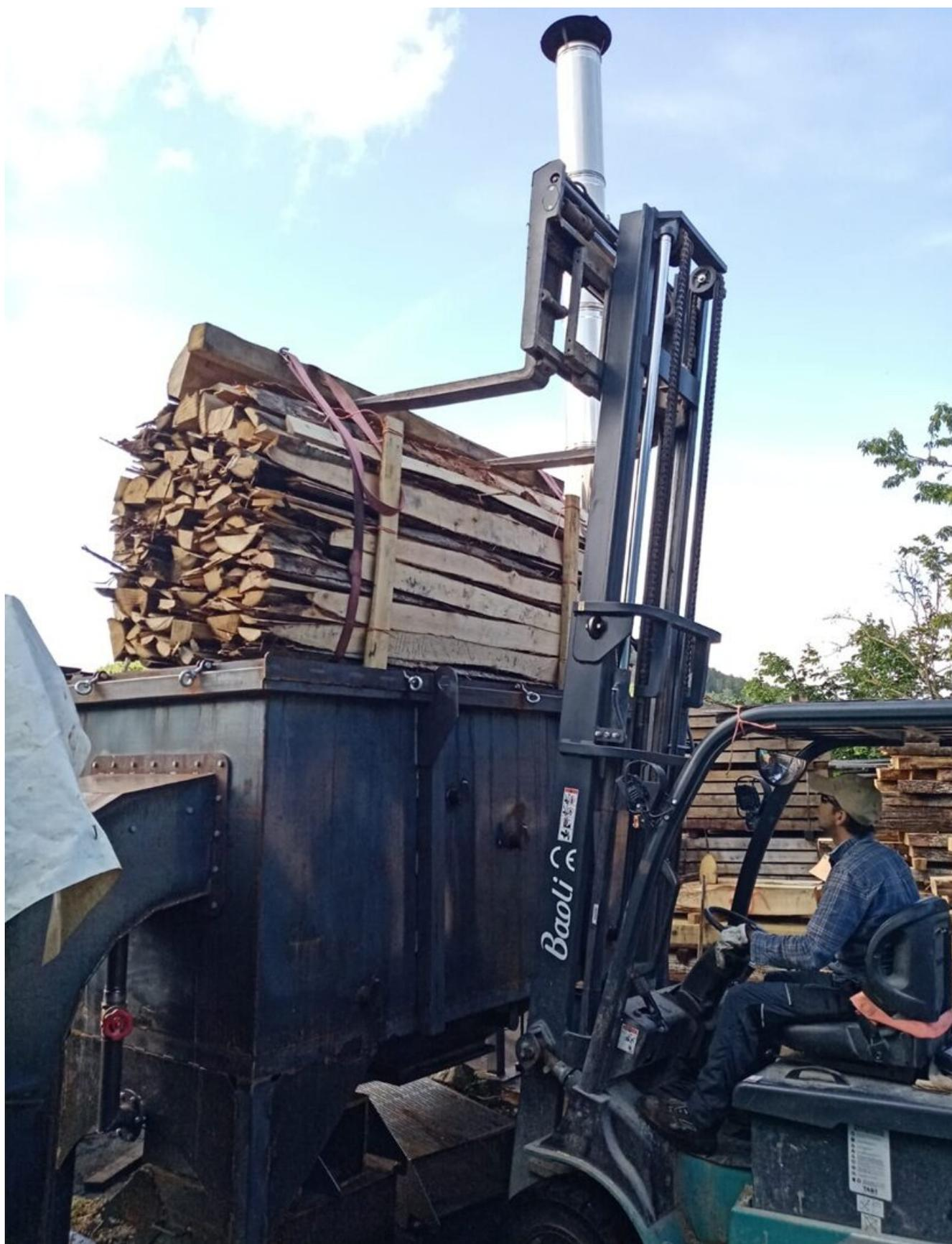
Fig. 2: carico meccanizzato del prototipo di carbonaia mobile, in questo caso impiego di residui legnosi di segheria (sciaveri).
