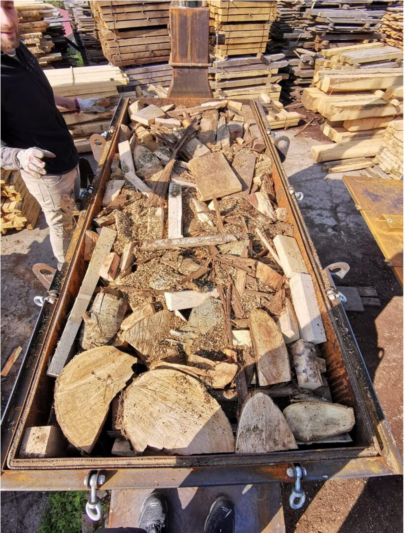
Fig. 3: prototipo caricato con residui di lavorazione del sistema di produzione paleria di castagno.
