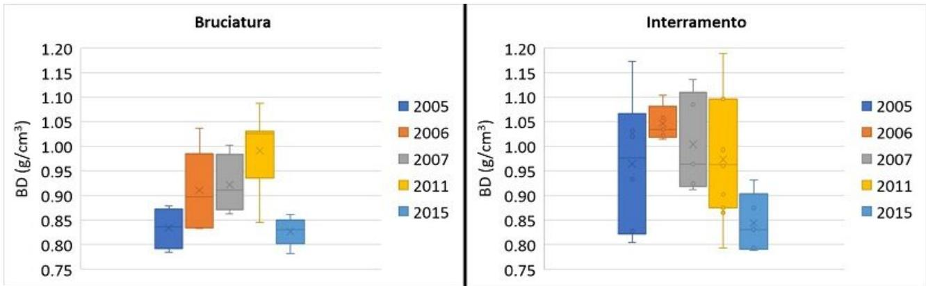
**Figura 1.** Diagramma a scatole (box plot) relativo al confronto dei valori di densità apparente del suolo secco (bulk density; BD) determinato nelle parcelle di suolo in cui la paglia di frumento è stata interrata direttamente durante le lavorazioni (interramento), o bruciata e poi interrata (bruciatura). All'interno delle singole "scatole", la croce (x) e la linea (–) rappresentano media e mediana, rispettivamente.
