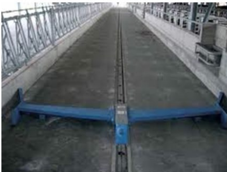
Figura 12 - Tipico raschiatore per la pulizia della corsia di alimentazione nelle stalle a stabulazione libera.
